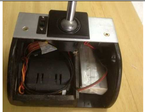
Confection d'un boîtier support de l'antenne et de l'interrupteur.
