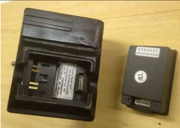
Pose de la HF amovible en fond de boîtier, ici une MPX
